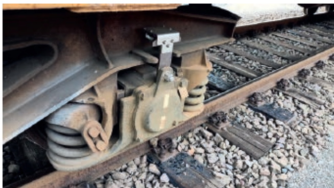
Рис. 2. Беспроводные бортовые датчики CTsensor для определения груженого или порожнего состояния вагона (слева) и для идентификации вагона (RFID) при проходе над путевым считывателем (справа)
