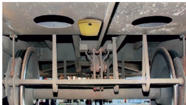
Рис. 2. Беспроводные бортовые датчики CTsensor для определения груженого или порожнего состояния вагона (слева) и для идентификации вагона (RFID) при проходе над путевым считывателем (справа)
