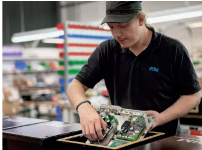
Рис. 5. Сборка бортового телематического устройства на предприятии PJM в Граце (Австрия)
