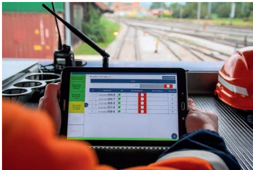
Рис. 9. Результат автоматического опробования тормозов на планшетном компьютере в кабине машиниста во время испытаний технологии на Федеральных железных дорогах Швейцарии
