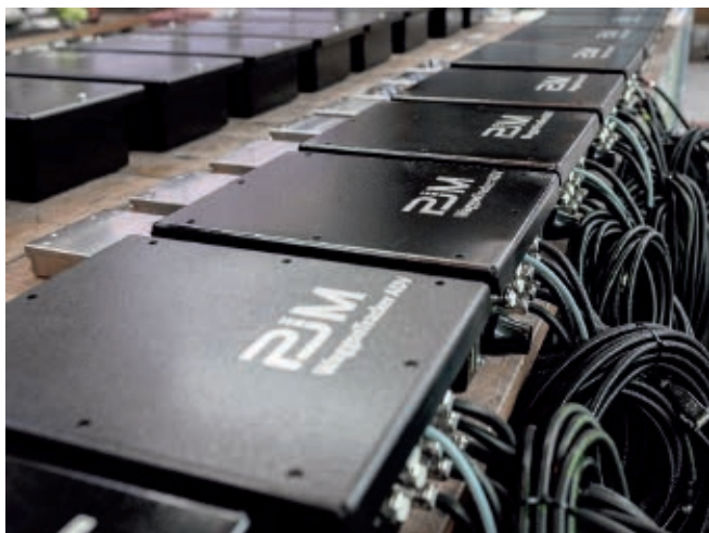
Рис. 6. Бортные телематические устройства во время тестирования на предприятии RJM
