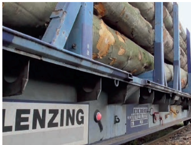
Рис. 7. Один из световых сигнализаторов на раме вагона (красный огонь оповещает о неравномерной загрузке)
