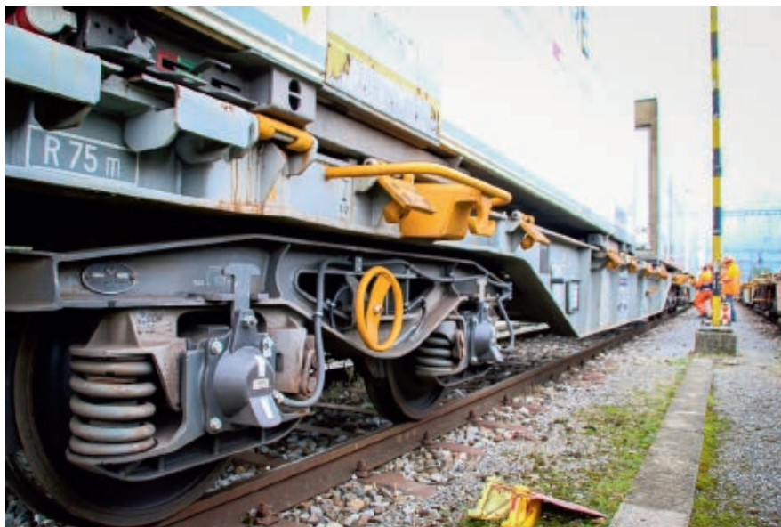
Рис. 2. Встроенные в концевые крышки букс электрогенераторы системы WaggonTracker
