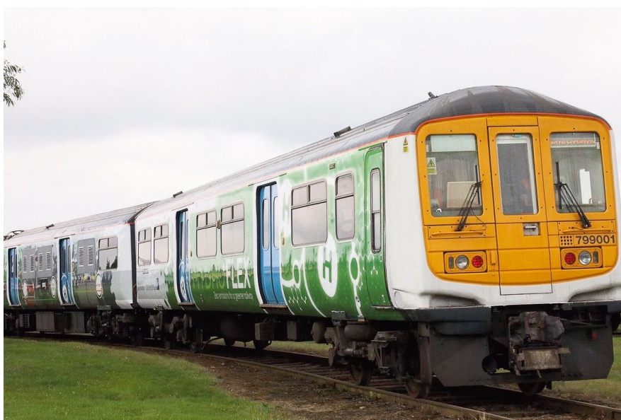
Рис. 3. Поезд HydroFLEX с питанием от топливных элементов проходит испытания в Великобритании
