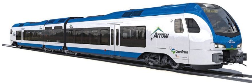
Рис. 4. Поезд на топливных элементах FLIRT H2, заказанный компании Stadler для округа Сан-Бернардино
