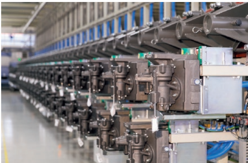
Воздухораспределители KAV60 во время испытаний на тормозном стенде завода Knorr-Bremse в Санкт-Петербурге
