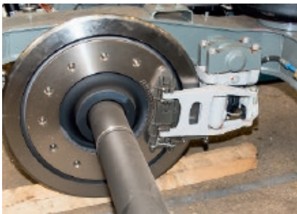
Дисковый тормоз компании Knorr-Bremse на тележке вагона дизель-поезда ДП-С для Сербии (фото: П. Яковлев)
