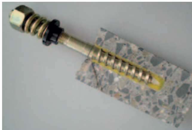
Рис. 4. Анкерный болт в изготовленном на месте дюбеле из затвердевшей реактивной смолы (показана желтым цветом)
