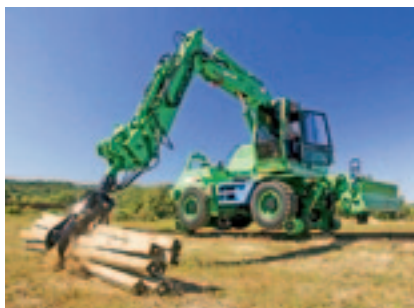
Рис. 1. Многофункциональный экскаватор типа 1085R Cruz Air на комбинированном ходу компании Badger
