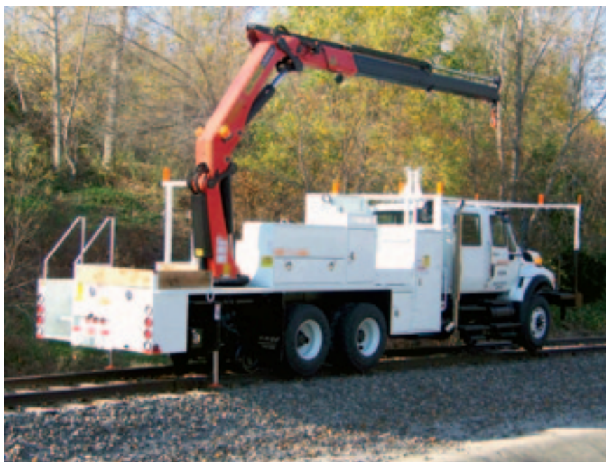
Рис. 6. Машина типа FBE 613 на комбинированном ходу компании Fleet Body Equipment
