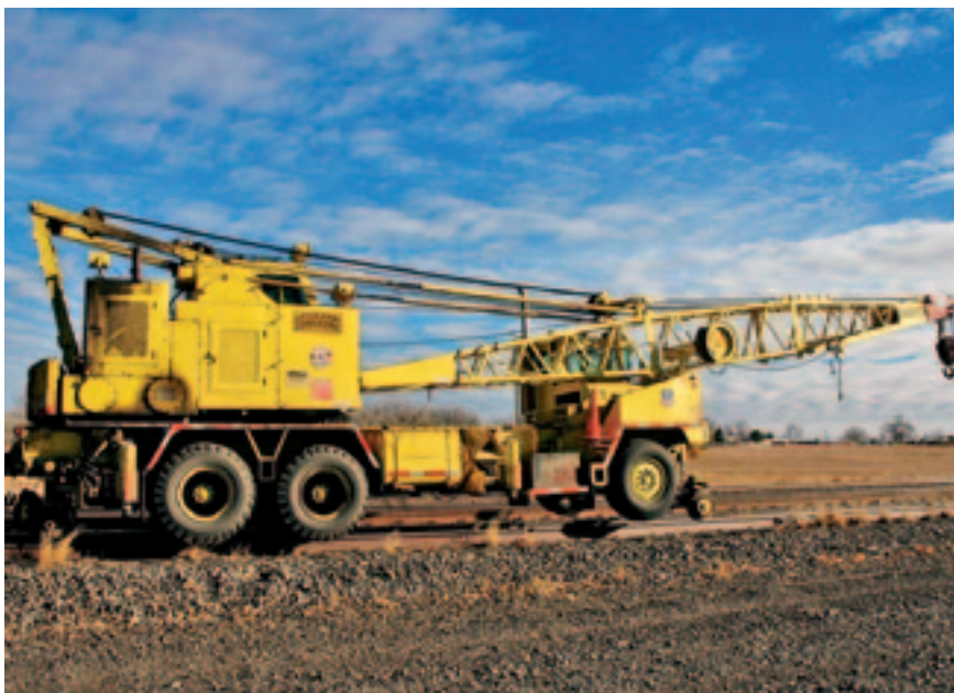
Рис. 2. Подъемный кран типа 64R на комбинированном ходу компании Little Giant
