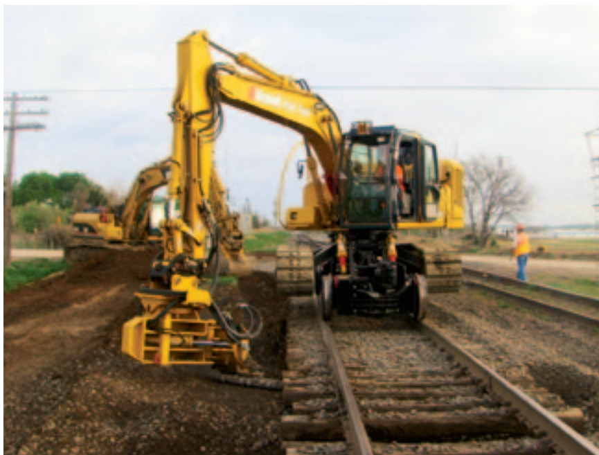
Рис. 5. Машина типа Brandt Rail Tool на комбинированном ходу
