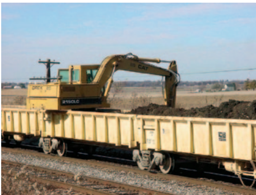
Рис. 8. Работа экскаватора поезда Slot Machine
