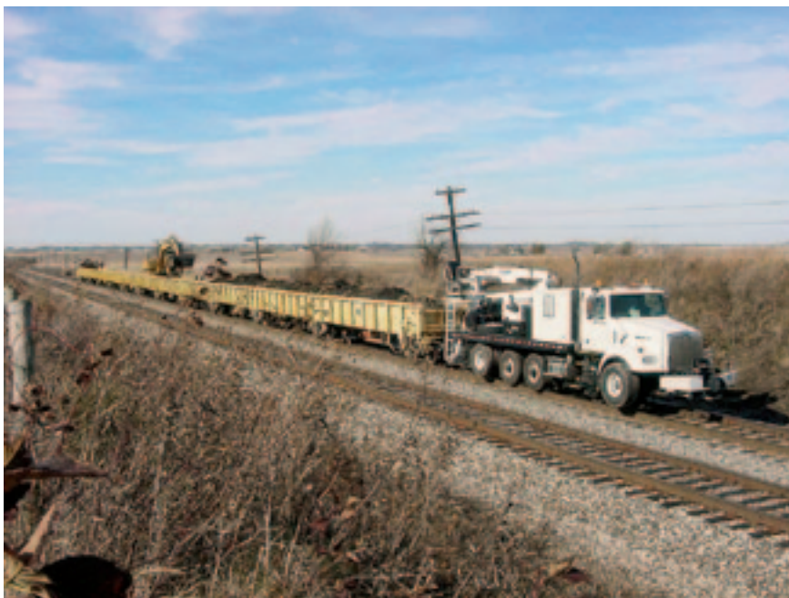
Рис. 7. Поезд типа Slot Machine компании Georgetown Rail Equipment
