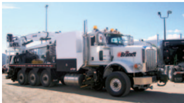
Рис. 4. Машина 6000 Brandt Power Unit на комбинированном ходу
