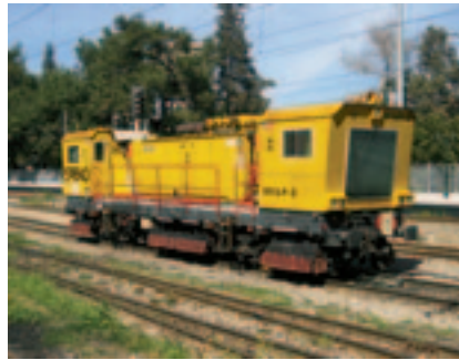
Рис. 10. Машина семейства RR 16 компании Speno нера информации можно распечатывать на принтере и выводить на сенсорный экран в режиме реального времени. Это позволяет оператору иметь точные сведения о состоянии рабочих поверхностей рельсов непосредственно перед шлифованием и после него. В компьютере предусмотрен удобный интерфейс для оператора.
