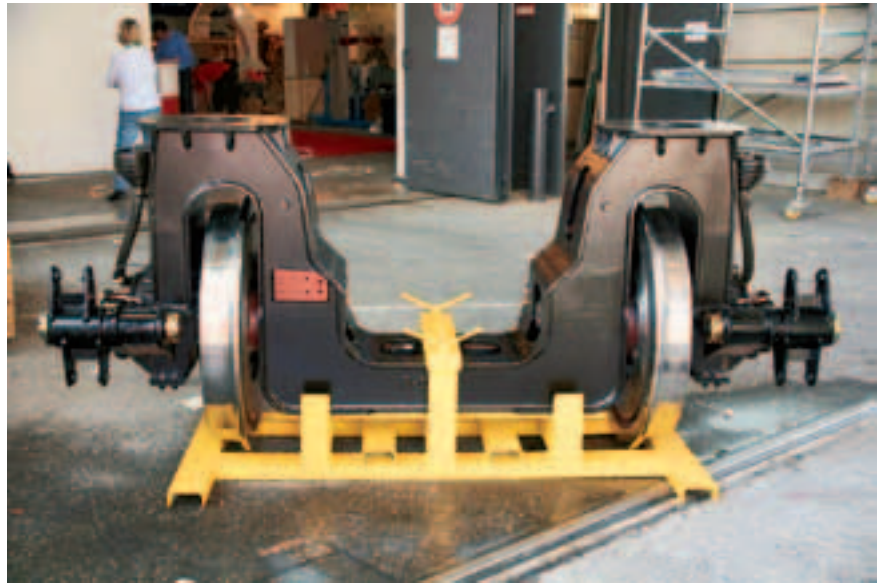
Рис. 3. Промежуточная тележка (без рессорного подвешивания)
