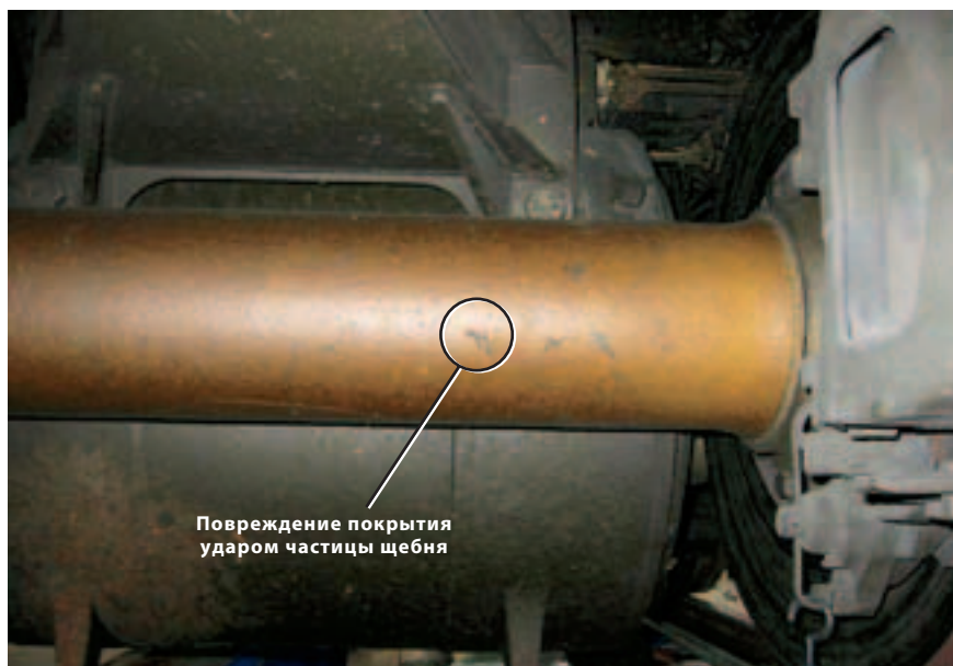
Рис. 2. Средняя часть оси с защитным покрытием (источник: Bochumer Verein Verkehrstechnik)
