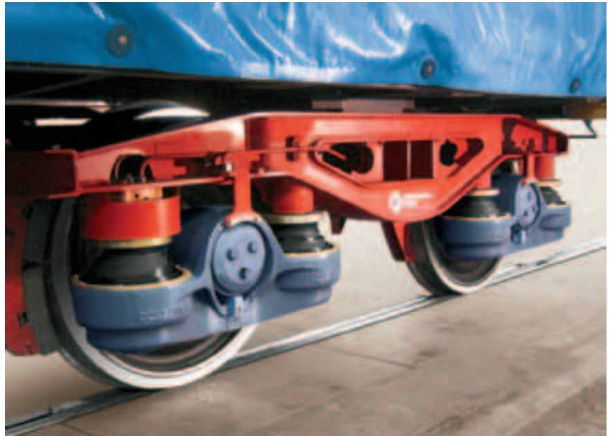
Рис. 2. Модифицированная тележка Y25, оборудованная буксовыми узлами Gigabox
