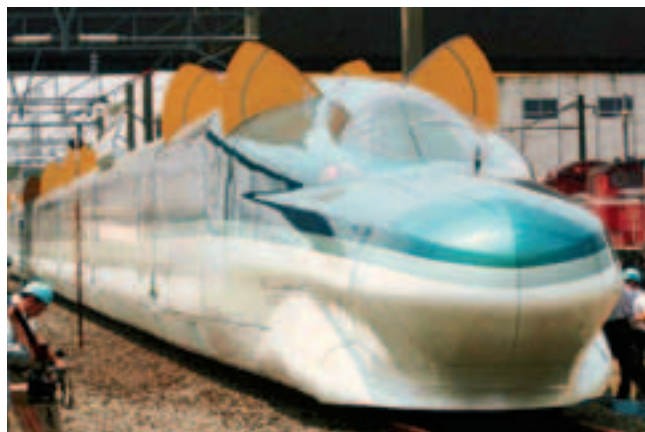
Рис. 2. Электропоезд Fastech 360S с выдвинутыми тормозными щитками (видны различия в очертаниях лобовых частей противоположных концов поезда)
