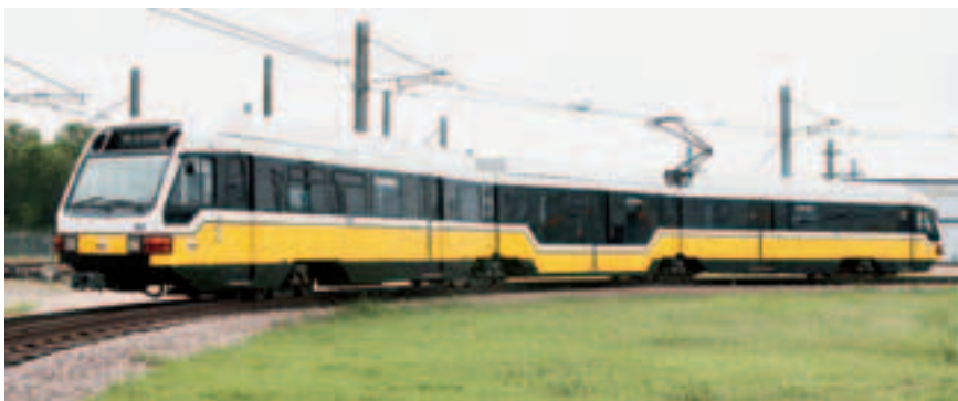
Рис. 2. Модернизированный вагон типа SLRV с промежуточной низкопольной секцией (фото: DART)
