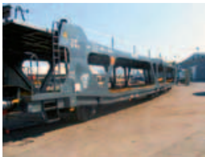
Рис. 4. Вагон типа Laekks для перевозки автомобилей в два яруса
