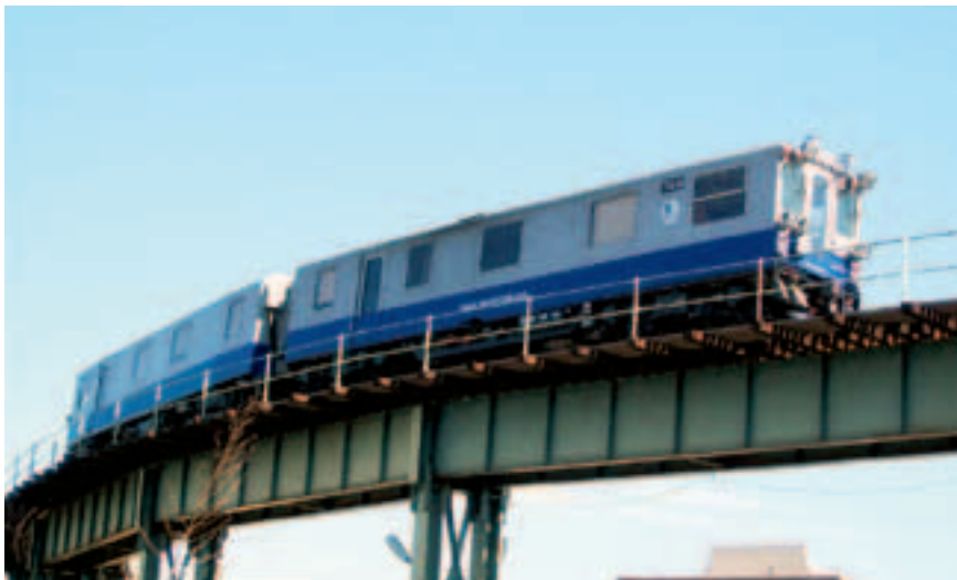
Путеинспекционный вагон типа TGC4 на одной из эстакад сети МТА-НУСТ
