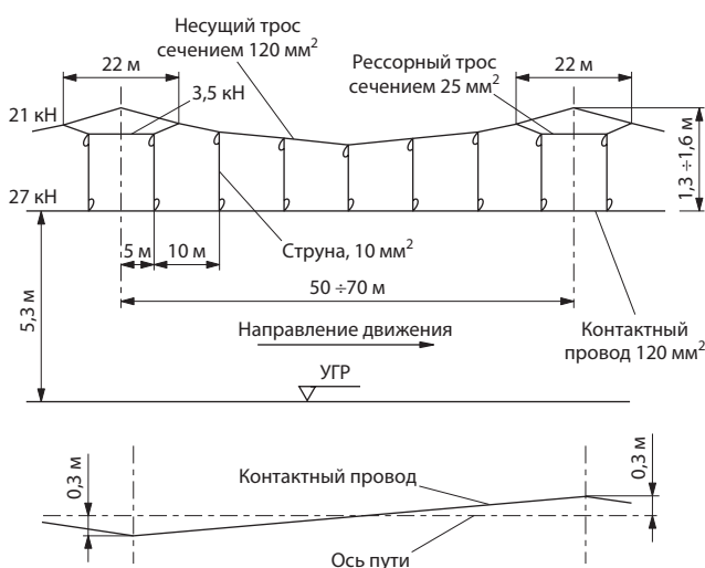
Рис. 3. Контактная подвеска Sicat HA для системы электроснабжения переменного тока 25 кВ/50 Гц
