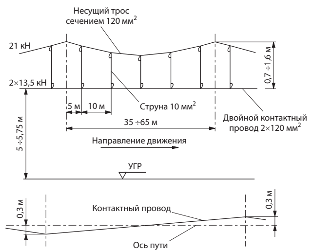
Рис. 4. Контактная подвеска Sicat SD постоянного тока напряжением 1,5 кВ
