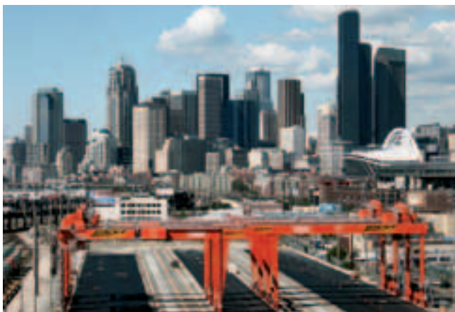
Рис. 1. Интермодальный терминал железной дороги BNSF в Сиэтле, оснащенный электрическими козловыми кранами
