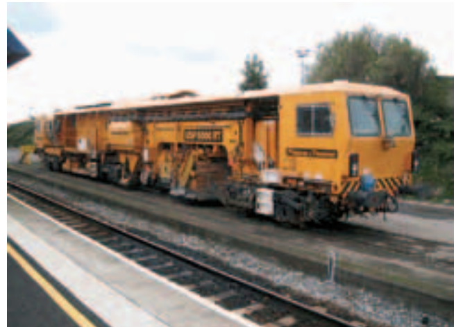
Рис. 4. Машина типа USP 5000 для планировки балластной призмы
