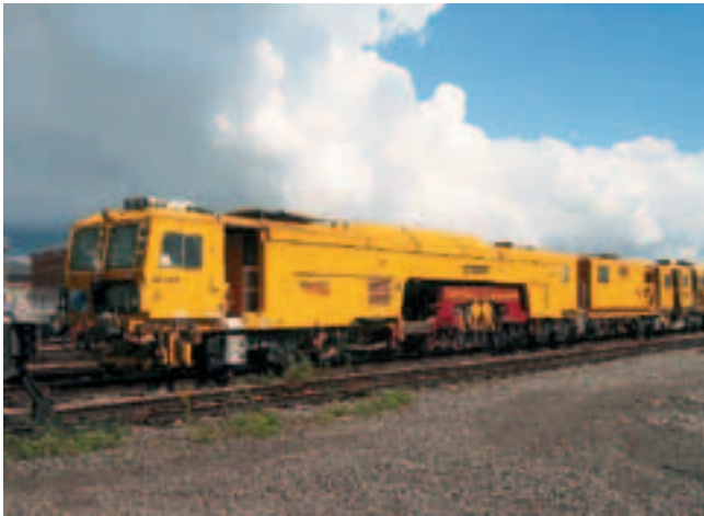
Рис. 3. Машина типа 09-3X для подбивки балласта и стабилизации пути
