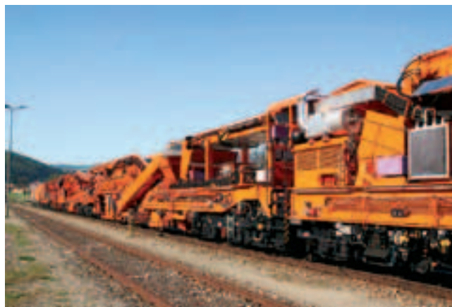
Рис. 2. Машинный комплекс типа RM 900 для очистки балласта
