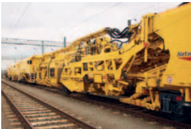
Рис. 1. Машинный комплекс типа P95 UK для обновления верхнего строения пути
