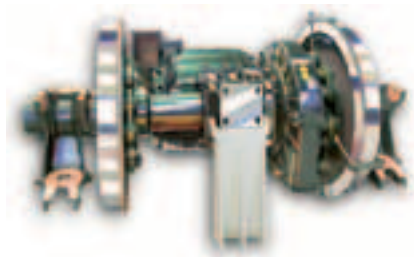
Рис. 2. Колесная пара с моторно-редукторным блоком для локомотивов
