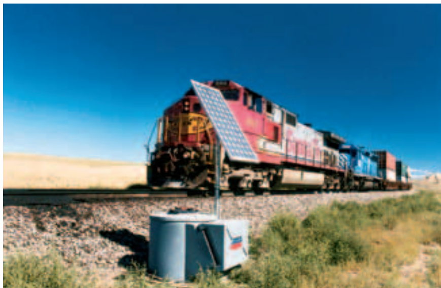
Рис. 1. Рельсовый лубрикатор компании Lincoln Industrial с питанием электрического привода от солнечной батареи на одной из линий железной дороги Burlington Northern Santa Fe
