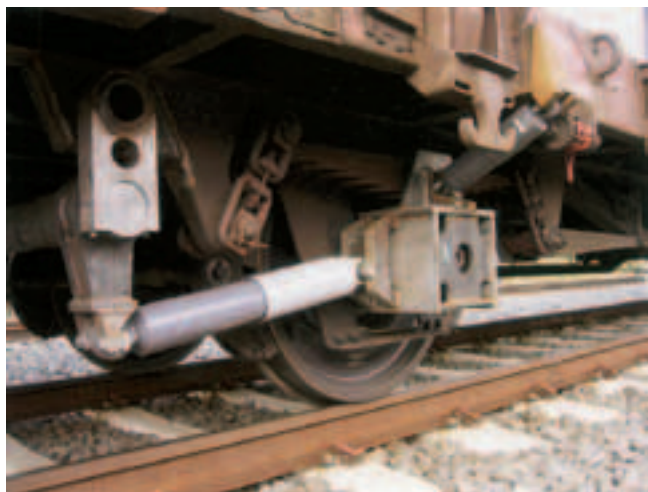
Рис. 6. Оснащение вагонов дополнительными гасителями колебаний: двухосного (слева) и четырехосного (гасители поперечных колебаний не показаны)
