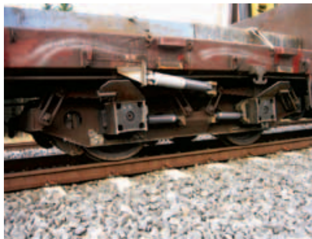
Рис. 6. Оснащение вагонов дополнительными гасителями колебаний: двухосного (слева) и четырехосного (гасители поперечных колебаний не показаны)
