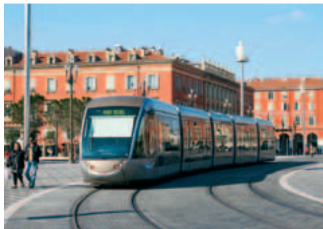
Рис. 8. Участок линии трамвая без контактной сети в центре Ниццы
