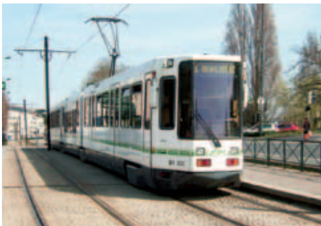
Рис. 7. Вагон типа TFS-1 с промежуточной низкопольной секцией в Нанте
