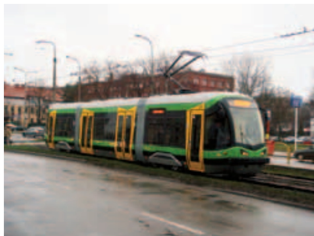
Рис. 4. Вагон трамвая типа 121N с низким полом постройки компании PESA в Эльблонге во время испытаний
