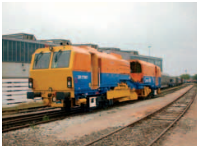
Рис. 5. Распределитель балласта типа R24
