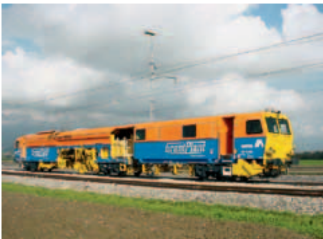
Рис. 2. Балластоподбивочная машина типа В41-UE
