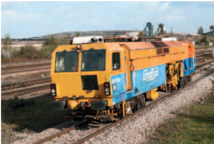
Рис. 1. Балластоподбивочная машина типа В45-UE
