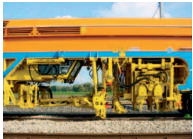
Рис. 3. Подбивочный узел машины В41-UE
