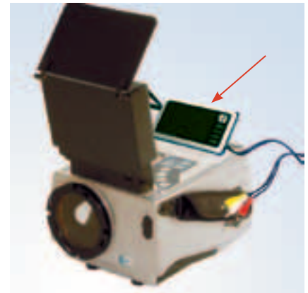
Рис. 8. Дополнительное оснащение камеры DayCor II в стандартной комплектации: вверху — пульт дистанционного управления (ПДУ); внизу — цифровой регистратор информации, установленный на верхней панели управления камерой (обозначен стрелкой)
