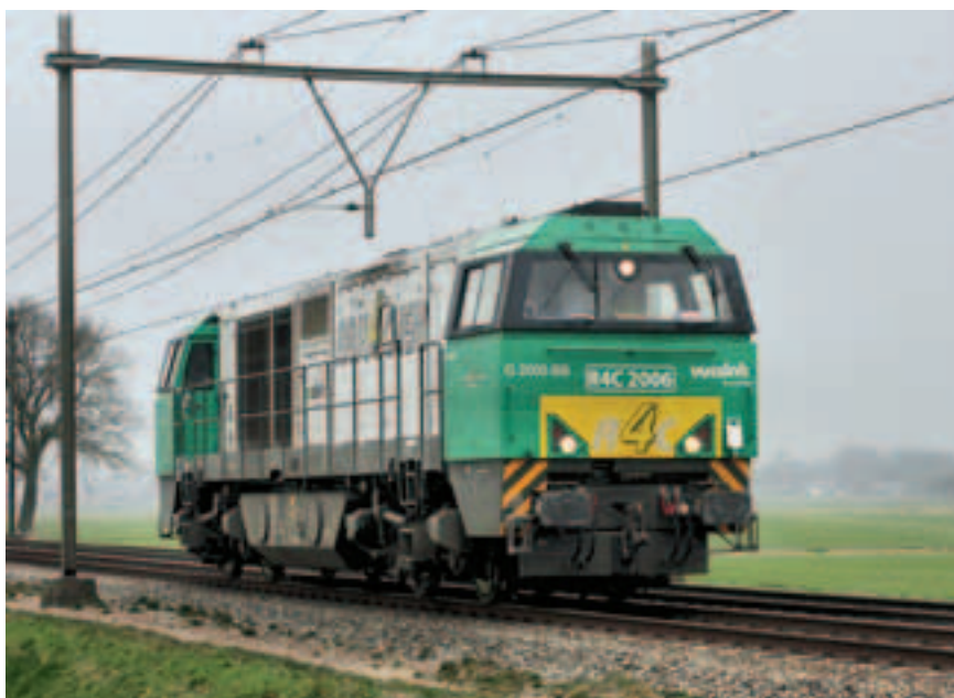
Рис. 10. Тепловоз серии G 2000 BB, построенный для частной компании-оператора Rail4Chem
