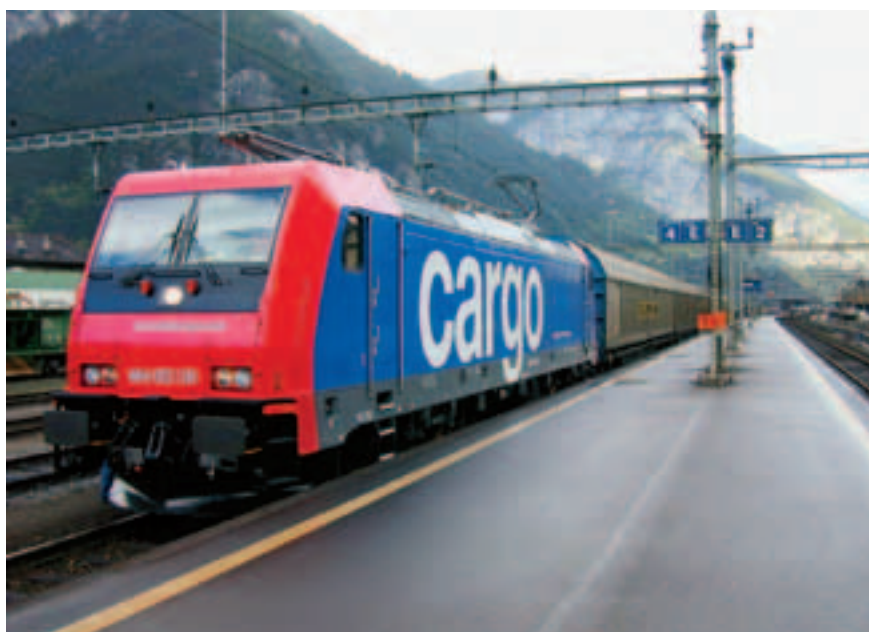
Рис. 8. Грузовой многосистемный электровоз семейства TRAXX, построенный по заказу железных дорог Швейцарии (фото: Bombardier)
