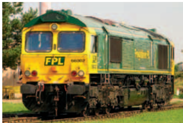
Рис. 12. Тепловоз серии 66 (JT42CWR), построенный для польского филиала британского оператора Freightliner
