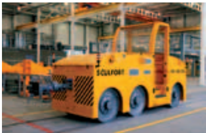
Рис. 4. Аккумуляторный мотовоз компании Sculfort
