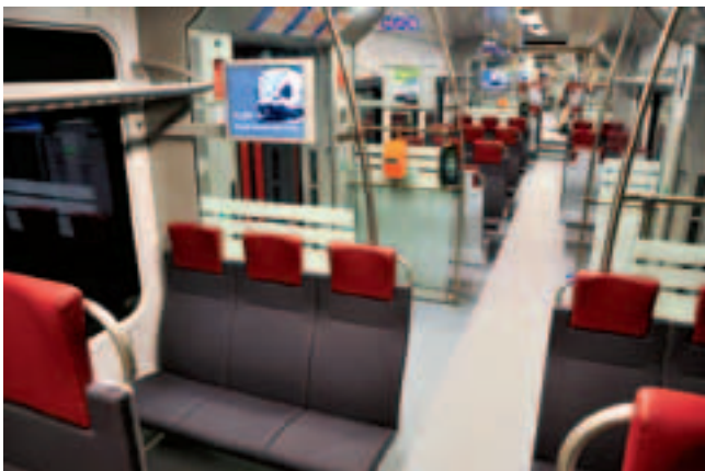
Рис. 5. Интерьер пассажирского салона поезда Sm5 (видны табло и дисплеи системы информирования пассажиров; фото: Pääkaupunkiseudun Junakalusto)
