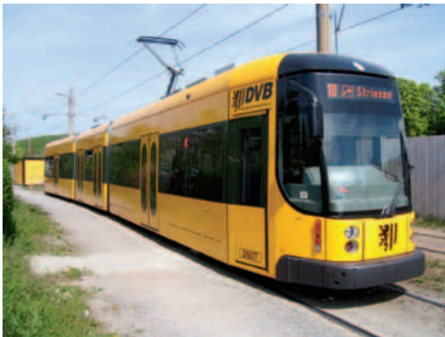
Рис. 4. Вагон трамвая Flexity Classic в Лейпциге, имеющий ходовую часть с внутренним опиранием осей
