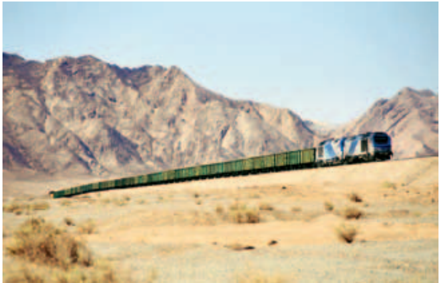
Рис. 2. Рудовозный поезд железных дорог Ирана, ведомый тепловозами Prima компании Alstom
