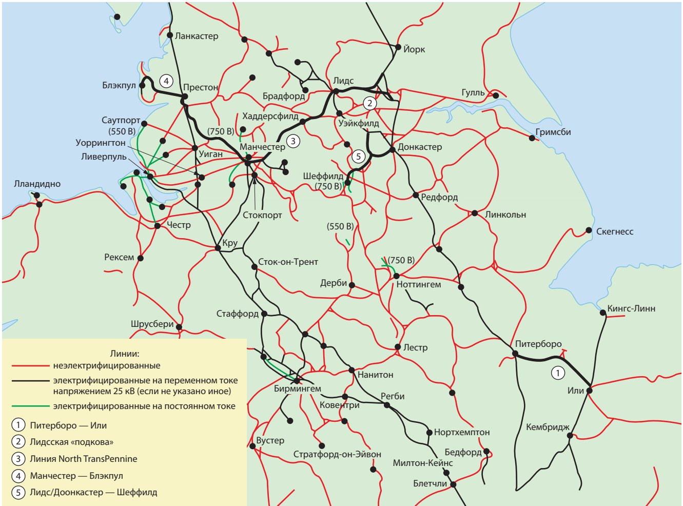
Рис. 2. Схема предложенных проектов точечной электрификации
