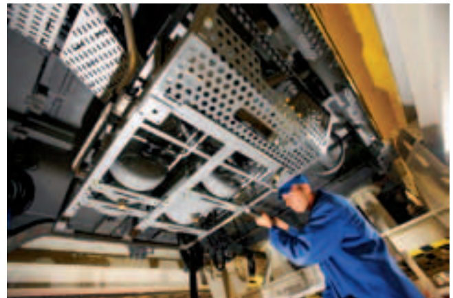
Рис. 6. Установка блока тормозной аппаратуры под кузовом вагона (фото: Bombardier)
