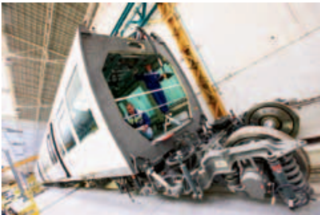
Рис. 5. Один из вагонов поезда на промежуточной немоторной тележке (фото: Bombardier)
