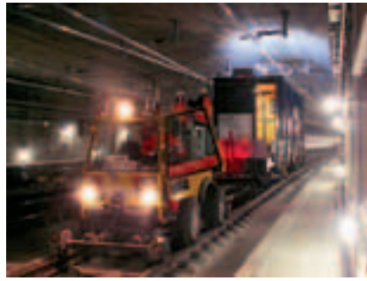
Рис. 6. Мобильная установка для динамического мониторинга контактной подвески (фото: Furrer+Frey)
