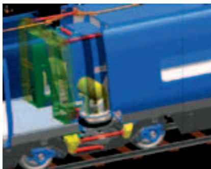
Рис. 4. Схема узла сочленения смежных вагонов (источник: Alstom)
