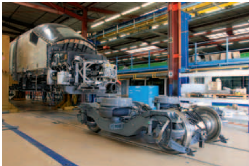
Рис. 6. Подкатка моторной тележки под кузов вагона поезда AGV (фото: Alstom)
