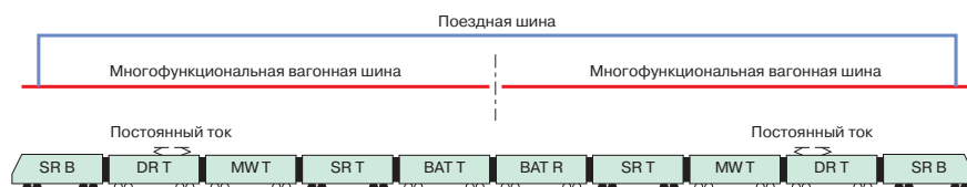
Рис. 20. Распределение системы шин TCN по вагонам на примере односистемного поезда В1
