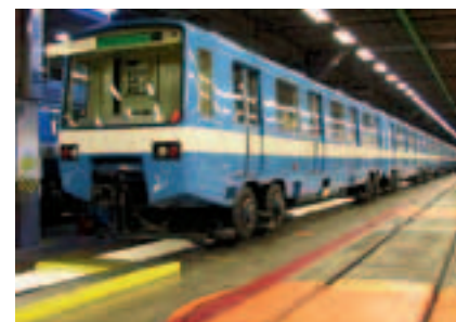
Рис. 7. Поезд на пневматических шинах постройки компании Canadian Vickers (Канада) в депо Богран метрополитена Монреаля
