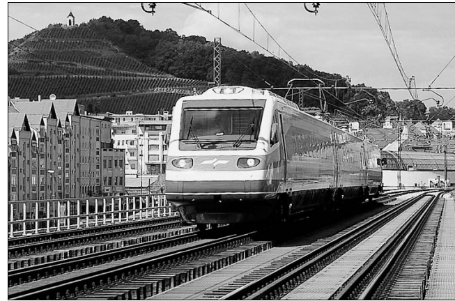
Рис. 3. Электропоезд из вагонов с наклоняемыми кузовами, изготовленный для SZ в Италии
