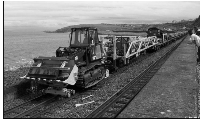
Рис. 3. Машинный комплекс NTC компании Harsco
