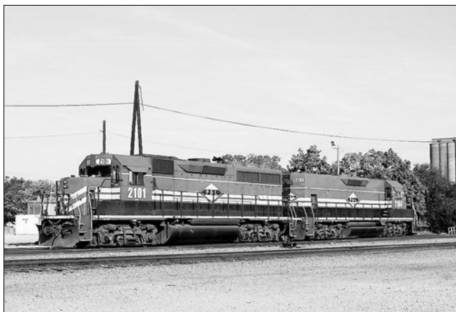
Рис. 6. Сплотка основного тепловоза и бустерной секции железной дороги Paducah & Louisville
