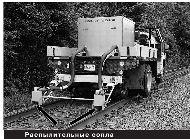
Рис. 4. Транспортное средство на комбинированном ходу, оснащенное устройством для нанесения модификатора трения на поверхность катания рельсов (фото: Kelsan)
