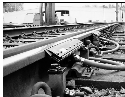
Рис. 2. Приспособление для нанесения модификатора трения на поверхность катания рельса (фото: Kelsan)
