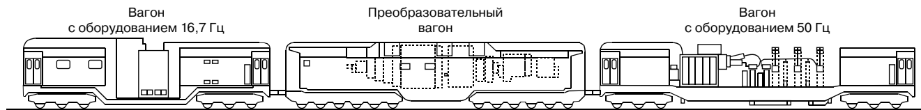
Рис. 2. Размещение оборудования передвижной подстанции на платформах
