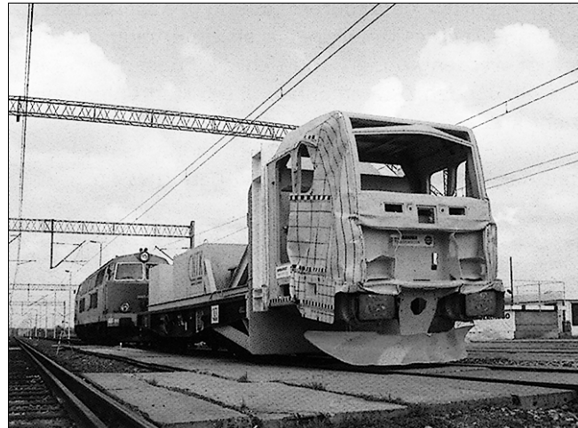
Рис. 6. Фронтальный сегмент кабины после экспериментального столкновения в испытательном центре Жмигруд компании CNTK в Польше
