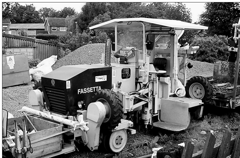
Рис. 4. Машина LFT для позиционирования новых шпал и крепления рельсов
