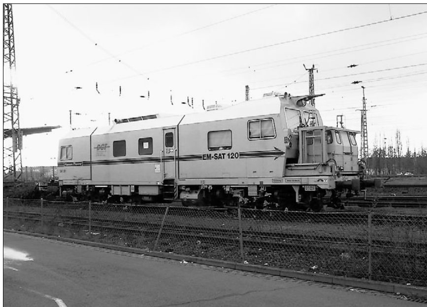
Рис. 1. Путьеизмерительный вагон EM-SAT
