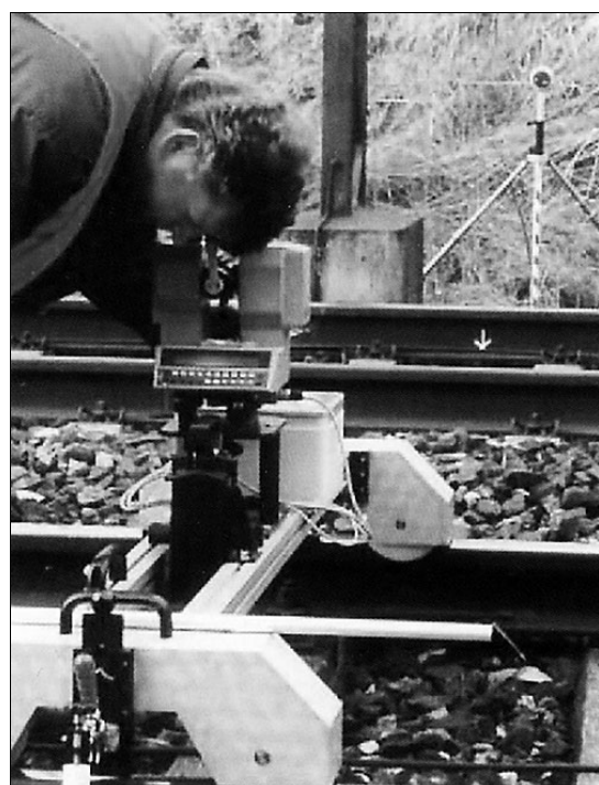
Рис. 2. Устройство для измерения в реперных точках
