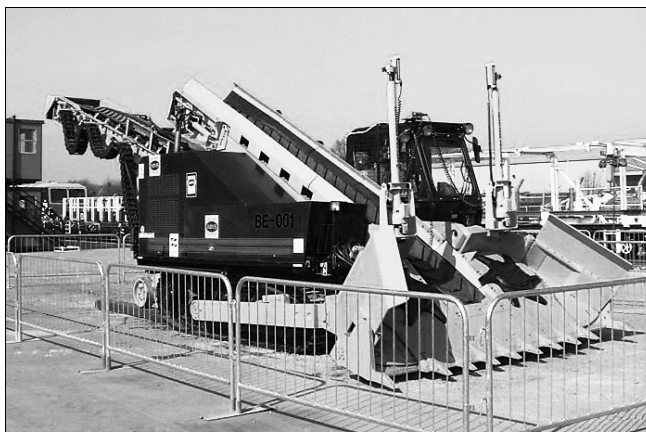
Рис. 10. Машина на гусенично-рельсовом ходу типа RBE-1
