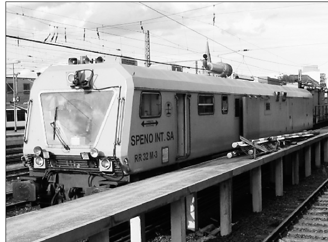
Рис. 1. Рельсошлифовальный вагон Speno 32
