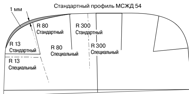
Рис. 6. Профиль Anti-Headcheck для кривых большого радиуса
