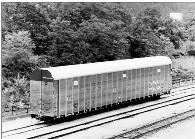
Рис. 3. Вагон VersaCoil компании Jonstown America для перевозки стали в рулонах
