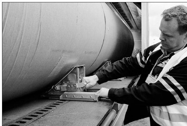
Рис. 14. Установка регулируемого башмака для закрепления бумажного роля в вагоне Habbiiins 344 (фото DBAG, Бреттманн)
