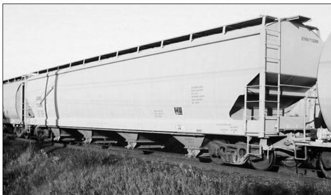
Рис. 1. Крытый вагон-хopper компании Trinity Industries объемом 180 м 3
