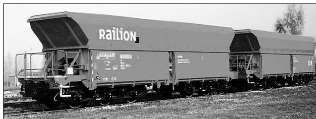
Рис. 1. Двухвагонная секция Falrfs 152/153 для перевозки сыпучих грузов горно-добывающей промышленности
