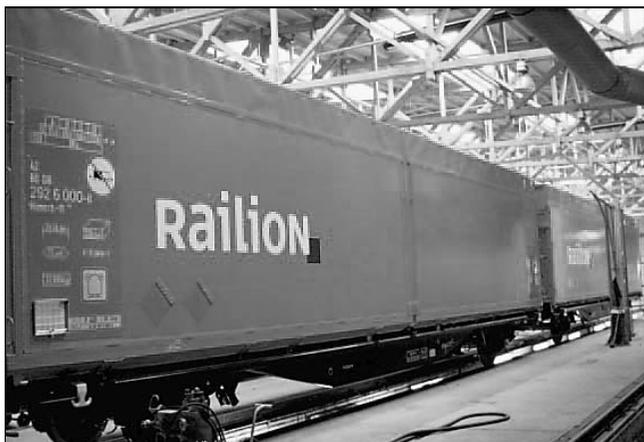
Рис. 6. Вагон большой вместимости Nimrrs-tt 326 с раздвижными стенками (Automotive Maxx)
