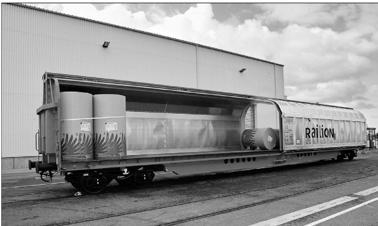
Рис. 13. Четырехосный грузовой вагон Habbiins 344 с раздвижными боковыми стенками (фото DBAG, Бреттманн)
