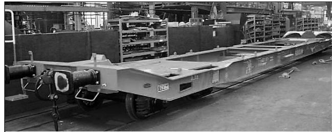
Рис. 9. Четырехосный вагон-платформа Sgkms 698 для перевозки контейнеров и обменных кузовов Jumbo
