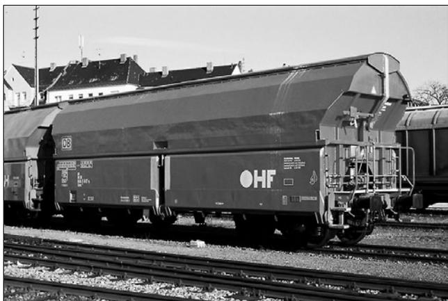
Рис. 12. Четырехосный вагон Talns 969/970 для вывоза гипса с тепловых электростанций, работающих на буром угле (фото DBAG, Вебер)
