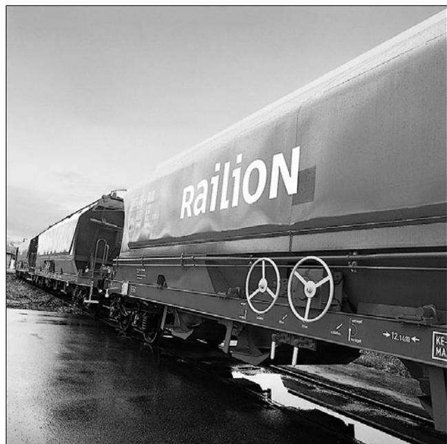
Рис. 11. Четырехосный вагон Tagnoos 898 для перевозки зерна (фото DBAG, Лаутеншлегер)
