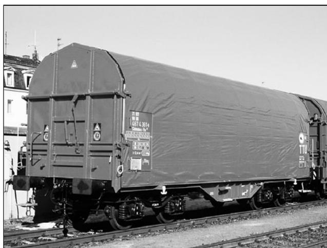
Рис. 4. Четырехосный вагон Shimms-ttu 723 для перевозки стального листа в ролях (фото DBAG, Вебер)
