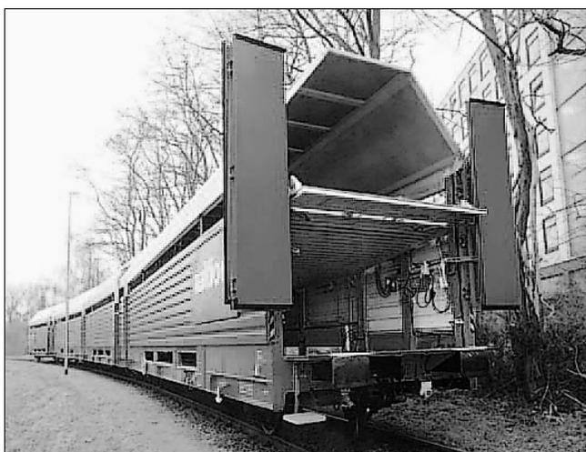
Рис. 8. Четырехвагонная секция Hsseefts 330 для перевозки автомобилей
