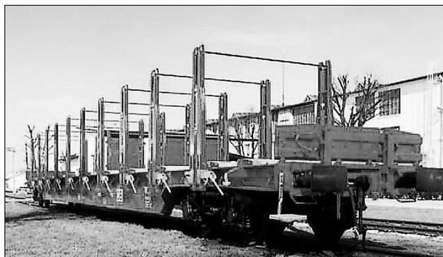
Рис. 2. Четырехосный вагон-платформа Rbns 646 для перевозки продукции металлургической промышленности
