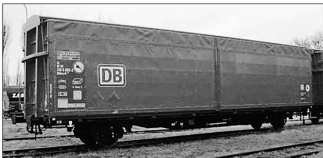
Рис. 5. Вагон большой вместимости Hbbins-tt 309 с раздвижными стенками для перевозки автомобильных запасных частей
