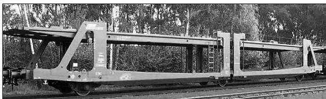
Рис. 7. Трехосный двухъярусный вагон-платформа Laes 559 для перевозки автомобилей
