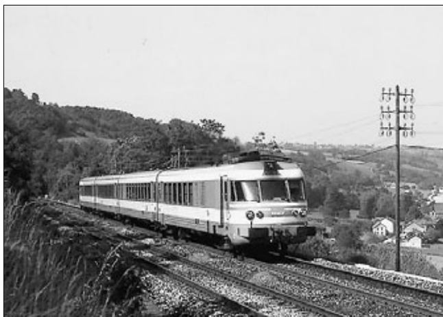
Рис. 17. Газотурбинный поезд ETG
