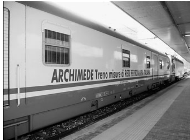
Рис. 14. Измерительно-инспекционный поезд Archimede (фото: И. П. Киселёв)
