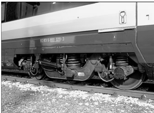
Рис. 12. Тележка прицепного вагона поезда ETR 500 (фото: И. П. Киселёв)
