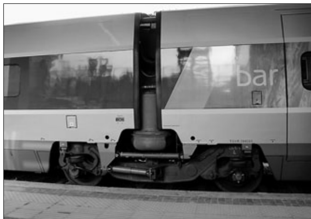
Рис. 22. Промежуточная тележка и узел сочленения прицепных вагонов поезда TGV Réseau (фото: И. П. Киселёв)
