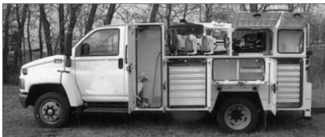
Рис. 3. Служебный автомобиль корпорации Maintainer с выдвижными инструментальными ящиками EZ Latch Alumadrawers
