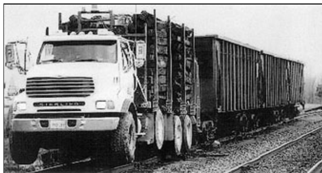
Рис. 1. Автомобиль компании Blackwood с прицепленными грузовыми вагонами
