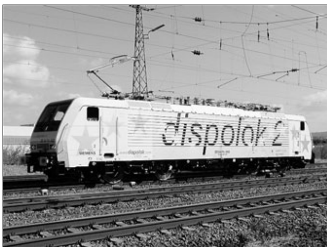
Рис. 1. Четырехсистемный электровоз ES64F4 компании Siemens Dispolok
