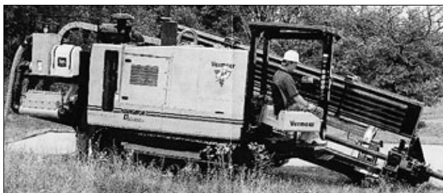
Рис. 2. Машина Navigator компании Vermeer для проходки горизонтальных и наклонных отверстий в грунте
